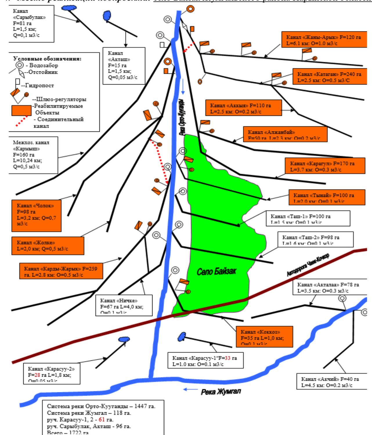
**Рис. №1. Прямолинейная схема внутрихозяйственной сети АВП «Токтомуш»**
